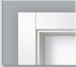
Konstruktionsfuge (stumpf gestoßen)
