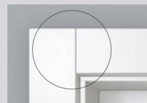
Konstruktionsfuge (stumpf gestoßen)
